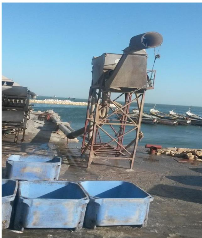
**Figure 3 : Pompe hydraulique pour le débarquement des poissons à quai**
