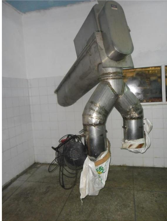
**Figure 11 : Ensacheuse de farine**
