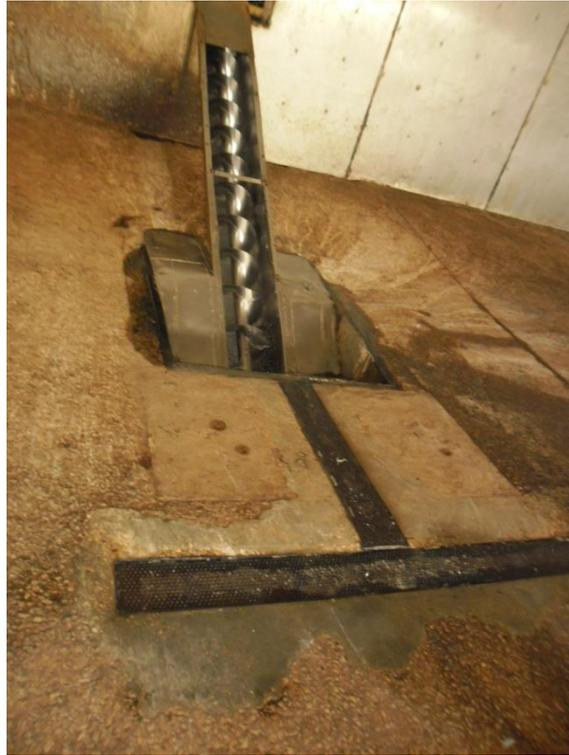
**Figure 7 : Salle de réception avec système de convoyage de la matière première**
