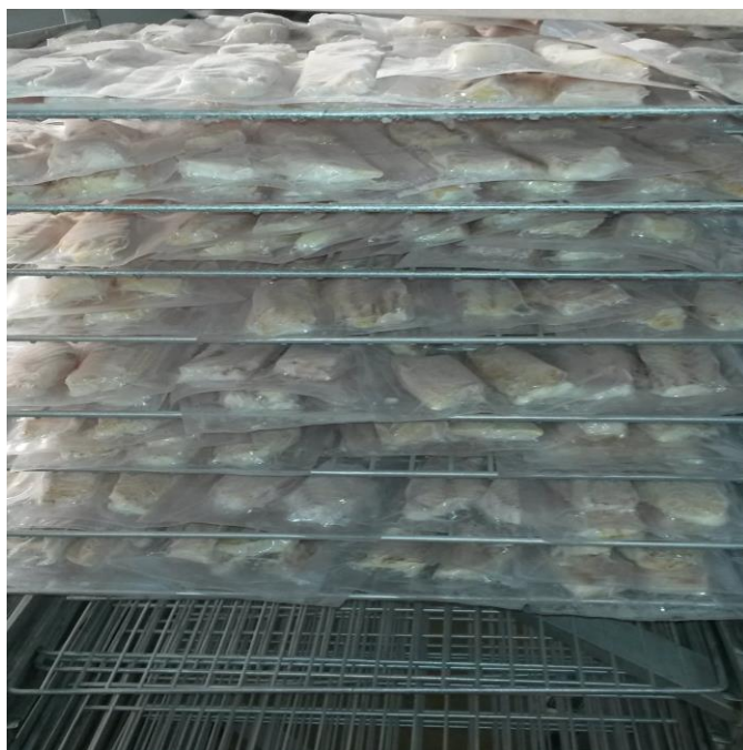
Figure 11 – Produits IQF à la sortie de congélation en tunnel
