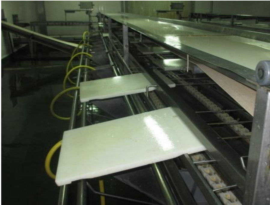
Figure 8 Chaîne de filetage en acier inoxydable avec table en téflon après nettoyage
